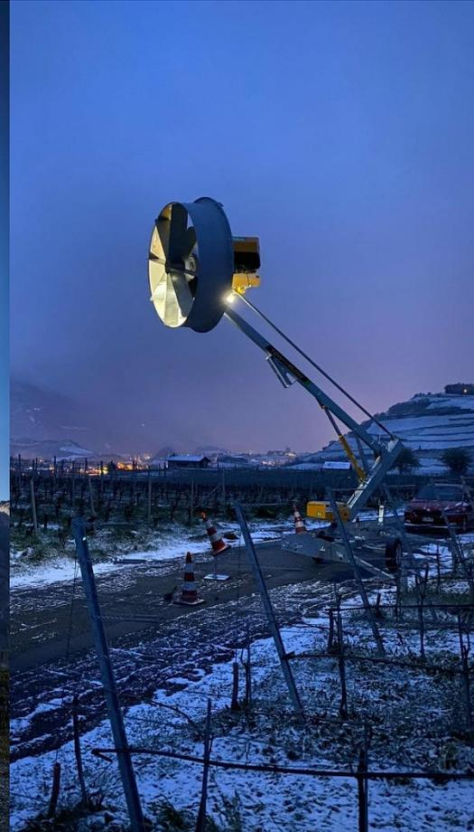
**Brassage de l'air** (apporter de l'air plus chaud dans la masse d'air froid)
